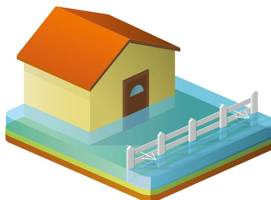
Figure 4 : Exemple de clôture assurant la transparence hydraulique.
